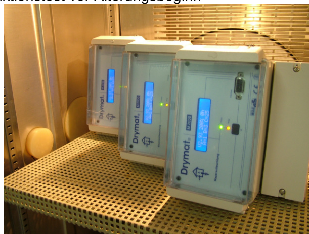
Abb.2: Funktionstest Drymat-Geräte vor Alterungsbeginn
