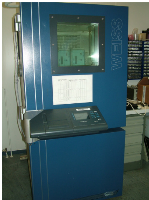
Abb.1: Klimaschrank WEISS SB11/160/40, mit Drymat-Geräten bestückt
