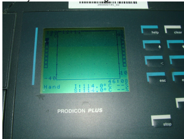
Abb.3: Soll- / Ist-Temperatur (114°C) und abgelaufene Zeitspanne (46h, 8min.) des Alterungstests
